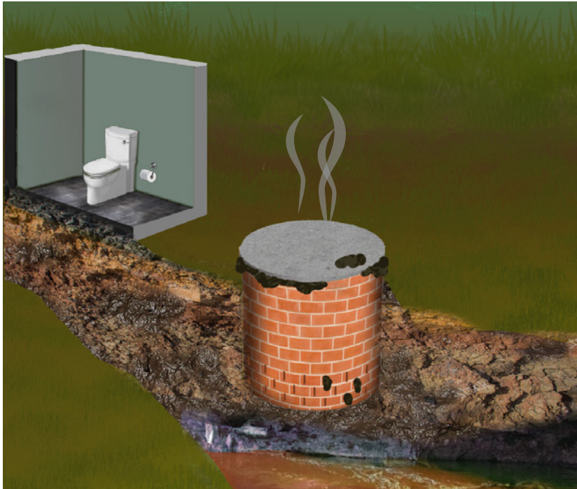
Figura 1. Ejemplo de pozo ciego rebalsando en la superficie y contaminando el agua subterránea.
